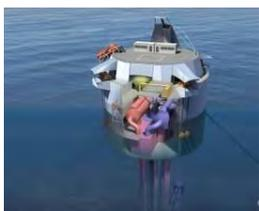
Espadon s'articule autour de la technologie Énergie Thermique des Mers. Il doit pérenniser l'utilisation d'un tuyau de conduite d'eau froide en vue de l'élaboration d'une future centrale thermique des mers. Sur ce projet, se sont mobilisés: DCNS, Total et Ifremer.
